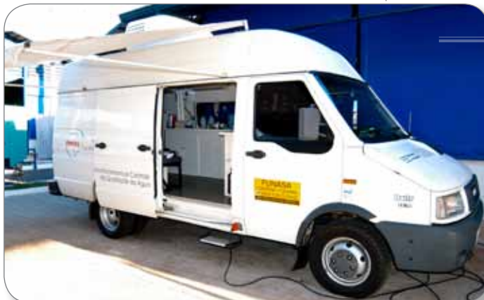
Unidade Móvel de Controle da Qualidade da Água (UMCQA)
